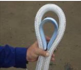
La estacha se une al grillete grande mediante una gaza. Esta gaza va provista de un "guardacabos" que la protegerá del desgaste. Si no ponemos este "guardacabos" la "estacha" se deteriorará rápidamente hasta romperse.
